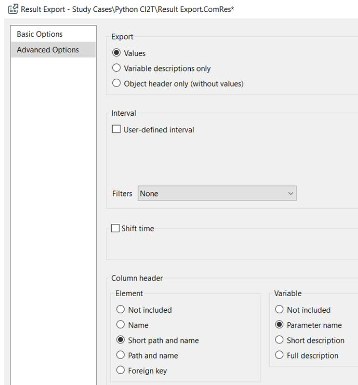
**Figure 11 : paramètres d'export des signaux de simulation au format CSV**
