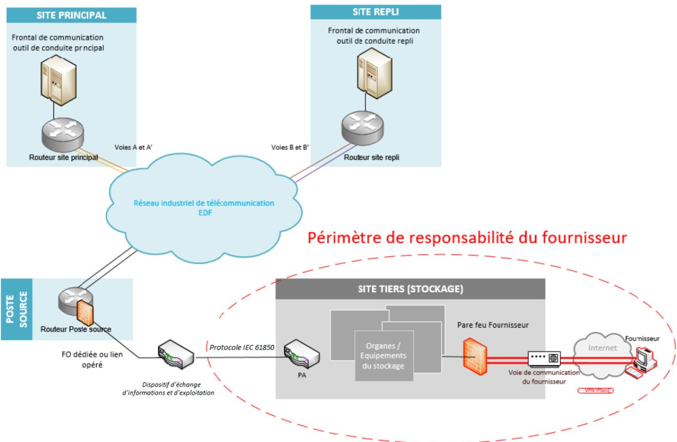
**Figure 10 : Schéma de l'architecture de communication**
