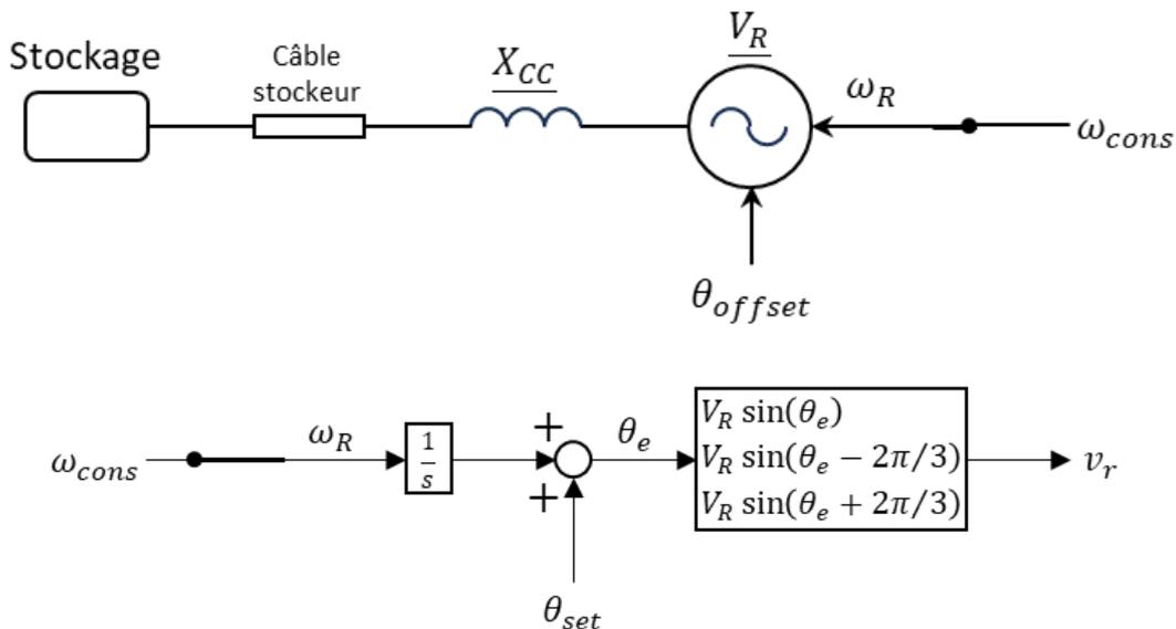
Figure 19 : modèle réseau pour la fiche 5
