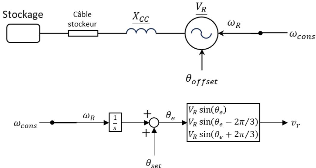
Figure 14 : modèle réseau pour la fiche 1
