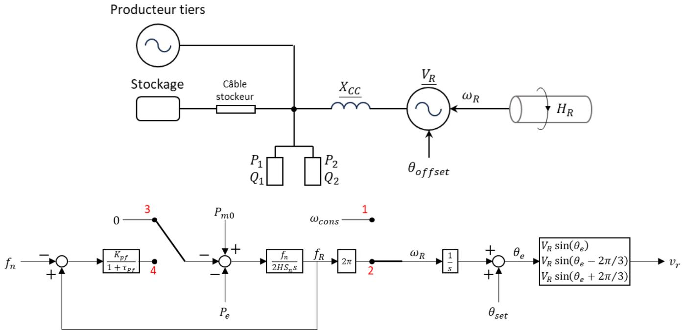
Figure 18 : modèle réseau pour la fiche 4
