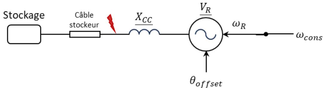
**Figure 21 : emplacement du court-circuit triphasé franc à simuler**
